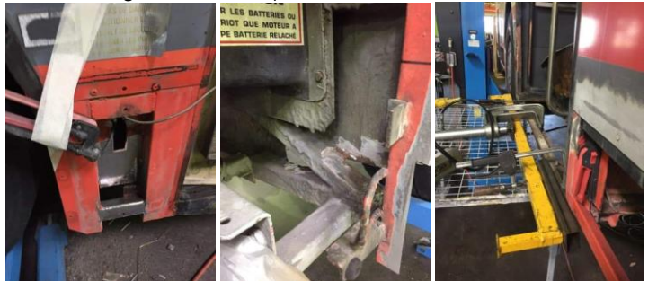
Autre mauvaise surprise, les carrossiers ont découvert une déformation et une dégradation avancée des marchepieds. Une tôle neuve et une reprise de l'embranchement avec le revêtement actuel permettront une rénovation économique, le tapis de couverture coûtant à lui seul, neuf, plus de 900 € !
