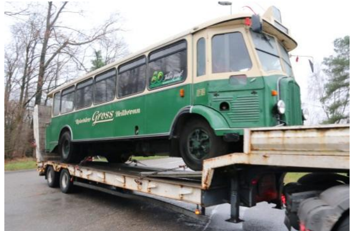
▲ - Le tout dernier véhicule rentré, en décembre 2019 : un Renault TN4H de 1937. Repéré en Alsace dans les années 1970 par le transporteur allemand Gross Reisen (Heilbronn), il a été restauré avec soin par cet entrepreneur qui a entièrement refait la structure en longerons métalliques. Il tombe aujourd'hui dans l'escarcelle d'AAF, par le truchement de son association-sœur « Deutsch-französische historische Omnibusse ». - © Jean-Louis Eschenlauer
