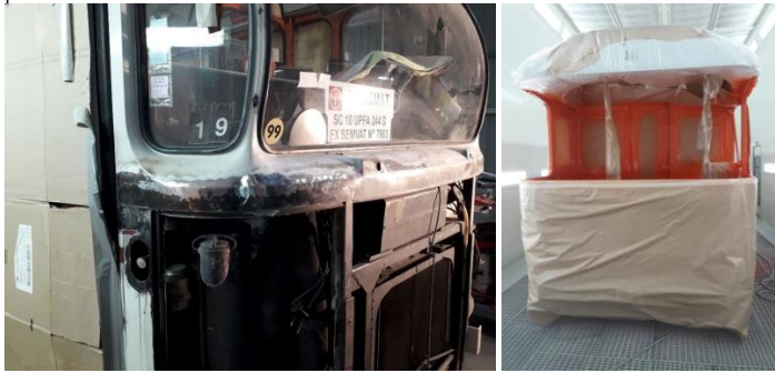
▲ - La ceinture de caisse entre la calandre et le pare-brise a été complètement assainie. Peinture de la ligne de vitres La tourelle de la plate-forme a été repeinte de manière bien plus professionnelle qu'à sa première rénovation en 2004 ! - © J.B. / M. C.
