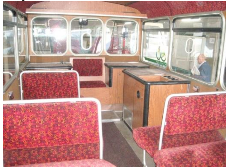
▼ - Restauration, façon Gross : l'autobus est aujourd'hui équipé d'une kitchenette avec frigo, d'un chauffage Webasto, d'une sonorisation et les sièges ont été recouverts de velours. - © Jean-Louis Eschenlauer
