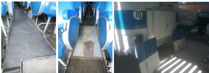
Réfection du tapis de sol et des volets de coffre arrière
