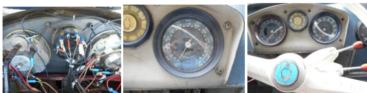
Réfection des câblages sous tableau de bord, du cadran du compteur et du commodo
