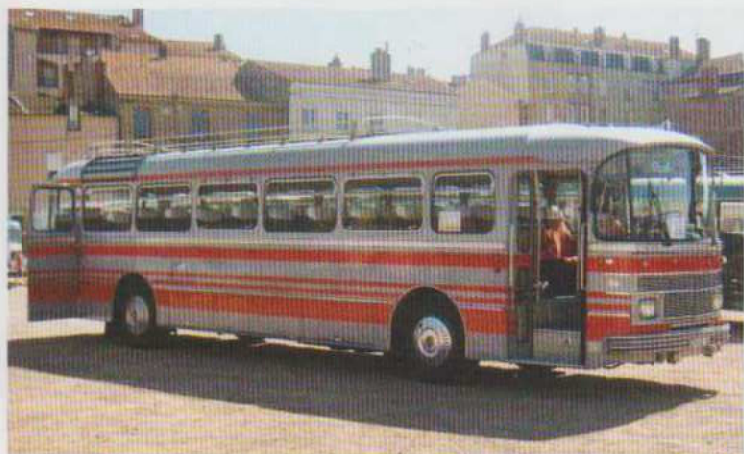
Acheté neuf par les Autocars Contadins de Carpentras (84) ce beau Saviem S 53M a été mis en circulation en 1977. Il appartient à François Bonnaud. Il pouvait transporter 49 passagers assis. Son moteur M.A.N de 165 chevaux était positionné couché entre les deux essieux.
