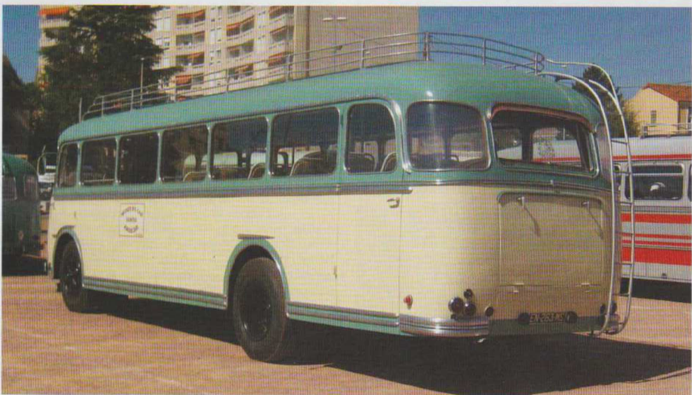
Ce Berliet PCK 8W appartient au Musée du Car de Vanosc (07). Mis en service en 1949, il a été carrossé par les Établissements Joseph Besset. Il est propulsé par un moteur Berliet 5 cylindres de 110 chevaux. Surnommé "Bébert" par les membres du musée, il a débuté sa carrière à Béziers pour le compte des Cars Vallat. Il a ensuite sillonné les routes du Puy-de-Dôme (63) lorsqu'il a été racheté par les Transports Proriot. Revendu à Mr Pignol, un habitant d'Hel-sinki, il est à Vanosc depuis 2012.
